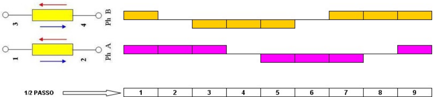
Fig. – 14 Sequenza 1/2 passo,motore bipolare
