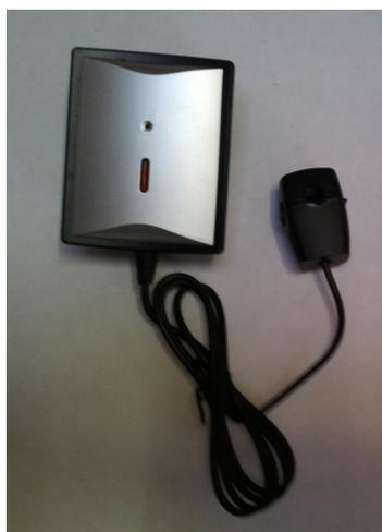
L'**MCEE Solar** è molto semplice da collegare e non richiede nessuna modifica all'impianto esistente. Infatti per rilevare i dati di consumo e produzione dai relativi impianti, vengono utilizzati due appositi trasmettitori wireless.
